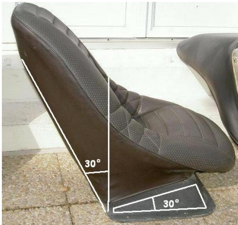
Pour donner une inclinaison au siège, il suffira d'ajouter sur le plat fixé sur les glissières une petite cale d'épaisseur suivant la meilleure position de chacun !
